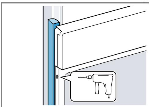
3. Fixer l'appareil avec une vis adéquate.
