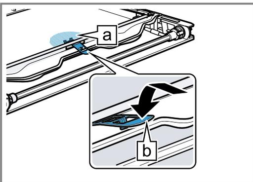
3. Ajuster la vitre intérieure au centre de la porte de l'appareil.
