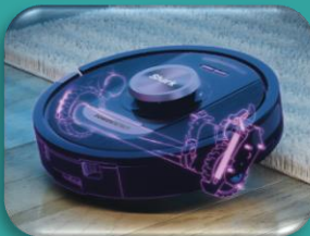
Technologie NeverStuck Soulève et abaisse activement pour manœuvrer au-dessus des obstacles, franchir les seuils et éviter facilement de rester coincé
