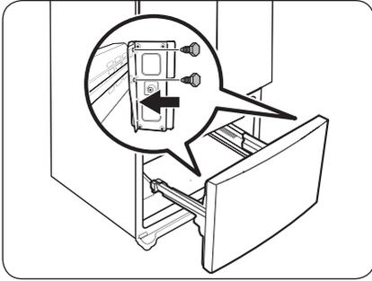
3. Utilisez une clé à douille (10 mm) pour fixer la porte que le rail à l'aide de 4 vis.
