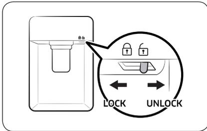
4. Posez un verre d'eau sous la sortie d'eau du distributeur, et poussez légèrement le levier du distributeur pour faire s'écouler l'eau. Assurez-vous que le distributeur d'eau est déverrouillé.
