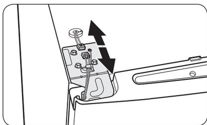
2. Débranchez les câbles sur la partie supérieure du réfrigérateur.
