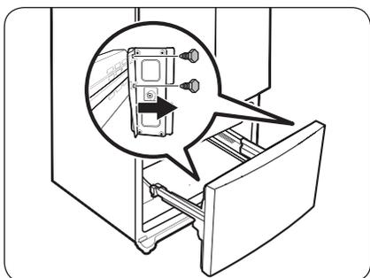
2. Utilisez une clé à douille (10 mm) pour retirer les 4 vis permettant de fixer la porte.
