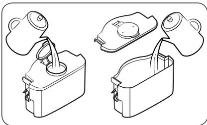
2. Remplissez le réservoir d'eau de 4 litres d'eau potable maximum. Vous pouvez retirer soit le bouchon supérieur, soit le cache pour verser de l'eau.
