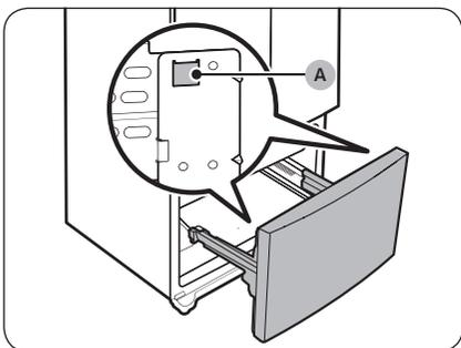
2. Installez la porte du congélateur sur les encoches (A) sur le côté des rails.
