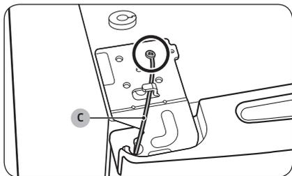
4. Utilisez un tournevis cruciforme pour retirer les vis permettant de fixer le **câble de mise à la terre (C)**.
