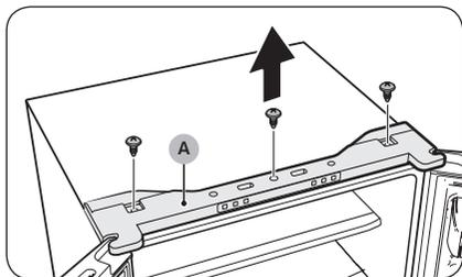
1. Utilisez un tournevis cruciforme pour retirer les vis permettant de fixer le **cache supérieur (A)**.
