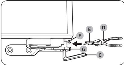
4. Utilisez la pince (D) pour insérer le circlip (E) fourni dans l'interstice entre l'œillet de charnière (F) et la charnière centrale (G). Le nombre de circlips à insérer dépend de l'interstice.
