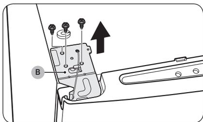
3. Utilisez une clé à douille (10 mm) pour retirer les vis permettant de fixer la **charnière supérieure (B)**.
