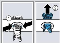
5. Passez les éléments filtrants sous l'eau courante pour les nettoyer.
