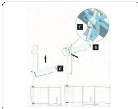
Pour fermer les casiers, les replier de la position (a) à la position (b). Assurez-vous que les clips sur la crémaillère s'adaptent sur le fil (c). La méthode inverse peut être utilisée pour ouvrir les racks. Les racks du système de rack multifonctionnel ont deux positions ; la position inférieure (d) et la position supérieure (e). Veillez à fixer correctement les crémaillères (f) sur le fil. Ne placez pas d'objets en contact avec le bras gicleur.
