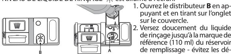
1. Ouvrez le distributeur **B** en appuyant et en tirant sur l'onglet sur le couvercle.
