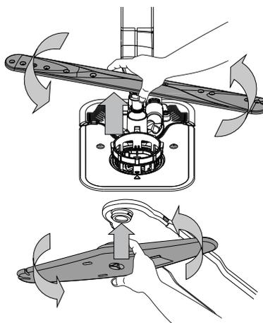
Le bras d'aspersion inférieur se démonte en le tirant vers le haut, tout en le tournant dans le sens inverse des aiguilles d'une montre.
