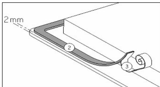
**Die Dichtung (2) nach Abnehmen der Schutzfolie (3) mit 2 mm Abstand von der Außenkanne des Glases aufkleben.**
