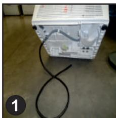
2. Le tuyau d'évacuation des eaux sales se trouve du côté droit de la machine (voir ci contre). Un tuyau gris est branché sur le raccord sur le côté gauche. A l'aide d'une pince, retirez l'étrier de fixation du tuyau de raccord.
