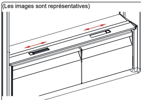
Si le compartiment à légumes est plein, le réglage flux d'air situé à l'avant du compartiment doit être ouvert. Ceci permet la pénétration de l'air dans le compartiment à légumes et le contrôle du taux d'humidité afin d'augmenter la durée de vie des aliments.
