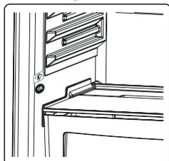
La zone la plus froide du compartiment réfrigérateur est délimitée par les autocollants collés sur le côté gauche de la paroi.
