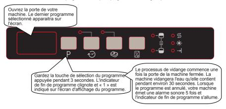
**Note**: Lorsque la porte de la machine est ouverte afin d'arrêter un programme de lavage avant sa fin, n'ouvrez dans un premier temps que légèrement la porte afin d'éviter des fuites d'eau.
