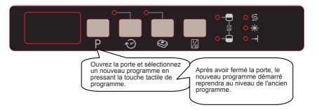
**Note**: Lorsque la porte de la machine est ouverte afin d'arrêter un programme de lavage avant sa fin, n'ouvrez dans un premier temps que légèrement la porte afin d'éviter des fuites d'eau.
