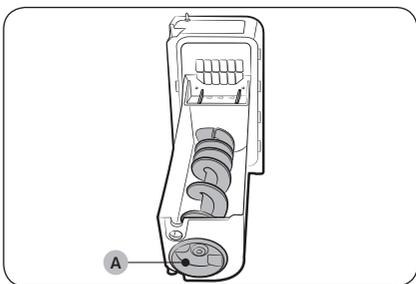
Si le bac à glaçons n'est pas fermement inséré, tournez la rampe hélicoïdale (A) de 90 degrés, puis réessayez.
