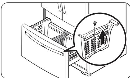
Desserrez et retirez la vis sur la partie inférieure de la grille de séparation. Ensuite, tirez la grille de séparation bien à la verticale pour la retirer.
