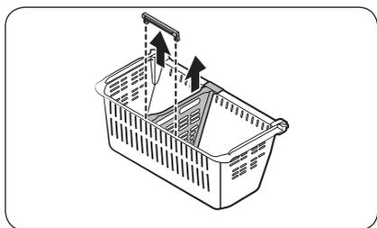
3. Tirez le **dispositif de fixation arrière** et la **grille de séparation** vers le haut pour les retirer.
