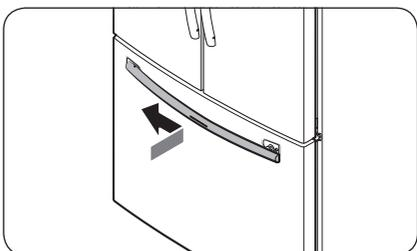
6. Pour installer la poignée du congélateur sur le réfrigérateur, placez tout d'abord le côté gauche de la poignée du congélateur sur la vis de poignée gauche, puis poussez-la vers la gauche.
