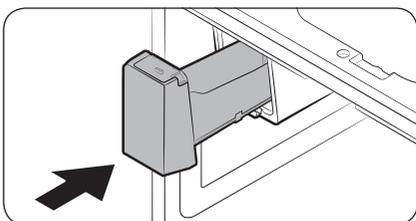
3. Une fois l'opération terminée, remettez le bac en place. Si vous n'arrivez pas à remettre le bac en place, faites tourner la vis hélicoïdale de 90 degrés puis réessayez.
