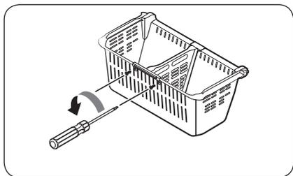
2. À l'aide d'un tournevis cruciforme, dévissez les deux vis maintenant en place le **dispositif de fixation arrière** à l'arrière du bac.
