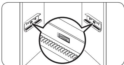
3. Pressez les crochets vers le bas pour déverrouiller l'ensemble de rail.
