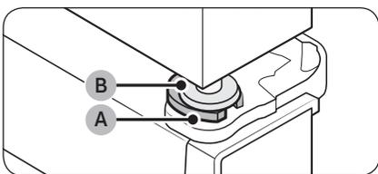
2. Insérez un circlip (A) de taille adaptée entre l'œillet de la porte (B) et la charnière, comme indiqué.
