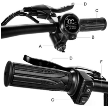
Açma bloğu (A): ekranı açmak/kapatmak için anahtarı açma bloğuna takın ve sağa doğru çevirin.
