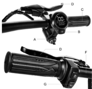
Stacyjka (A), aby włączyć/wyłączyć wyświetlacz, włożyć kluczyk do stacyjki i przekręcić kluczyk w prawo.
