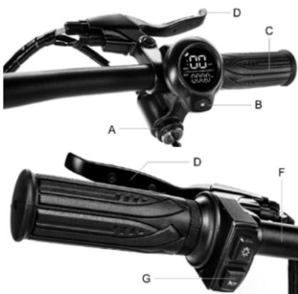
Štartovací blok (A), na zapnutie/vypnutie displeja vložte kľúč do štartovacieho bloku a otočte kľúčom doprava.
