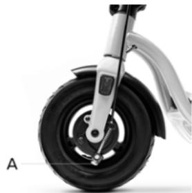
Als de rem te strak of te los zit, handel dan door de schroef (A) los of vast te draaien.
