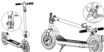
Sicherstellen, dass der Elektroroller ausgeschaltet ist. Halten Sie die Lenkersäule mit der Hand, ziehen Sie den Hebel, klappen Sie die Lenkersäule zur Fußstütze und rasten Sie ein.
