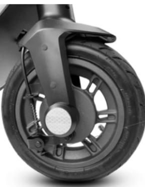
Jeśli hamulec jest zbyt ciasny lub zbyt luźny, użyj klucza imbusowego, aby poluzować śrubę (A), a następnie dostosuj linkę hamulca (jeśli jest zbyt ciasna, skróć linkę hamulca pociągając do góry, jeśli jest zbyt luźna, pociągnij linkę hamulca do dołu) i ponownie dokręć śrubę (A).
