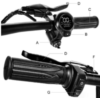
Startovací zámek (A), chcete-li displej zapnout/ vypnout, zasuňte klíč do startovacího zámku a otočte jím doprava.
