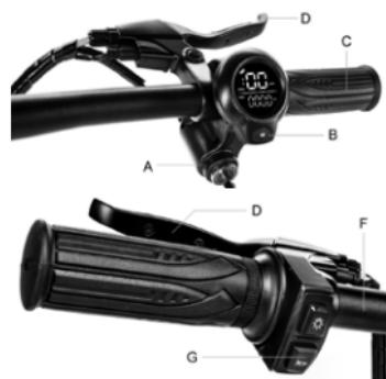
Contactslot (A), om het display in-/uit te schakelen, moet de sleutel in het contactslot worden gestoken en rechtsom gedraaid worden. Functieknop (B): druk 1 maal kort op de knop (B)
