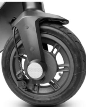
Σε περίπτωση που το φρένο είναι πολύ σφιχτό ή πολύ χαλαρό, χρησιμοποιήστε το κλειδί allen για να χαλαρώσετε τη βίδα (A) και έπειτα ρυθμίστε το καλώδιο του φρένου (κοντύνετε το καλώδιο του φρένου προς τα επάνω εάν είναι πολύ σφιχτό, ενώ αν είναι πολύ χαλαρό, τραβήξτε το καλώδιο του φρένου προς τα κάτω) και έπειτα, ξανασφίξτε τη βίδα (A).
