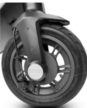
U slučaju da je kočnica previše zategnuta ili previše labava, koristite imbus ključ da olabavite zavrtanj (A), a zatim podesite sajlu kočnice (skratite sajlu kočnice nagore ako je previše zategnuta, ako je previše zategnuta povucite kabl kočnice nadole), a zatim ponovo pritegnite zavrtanj (A).
