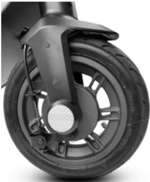
Wenn die Bremse zu fest oder zu locker ist, lösen oder ziehen Sie die Schraube (A) an.
