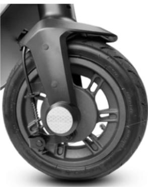
Si le frein est trop serré ou trop lâche, utilisez la clé allen pour desserrer la vis (A), puis ajustez le câble de frein, (raccourcissez le câble de frein vers le haut s'il est trop serré, s'il est trop lâche, tirez le câble de frein vers le bas) et ensuite, resserrez la vis (A).
