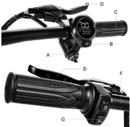
Brava za paljenje (A), za uključivanje/isključivanje ekrana stavite ključ u bravu za paljenje i okrenite ključ udesno.
