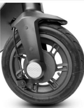
Pokud je brzda příliš utažená nebo příliš volná, povolte imbusovým klíčem šroub (A), poté seřidte brzdové lanko (pokud je příliš utažené, zkratě brzdové lanko směrem nahoru, pokud je příliš volné, stáhněte brzdové lanko směrem dolů) a poté šroub (A) opět utáhněte.
