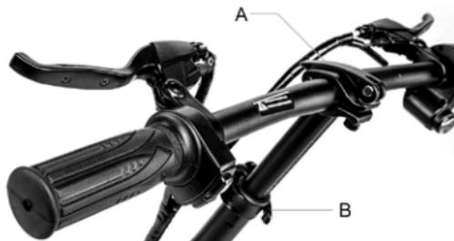
Sie können die Neigung des Lenkers einstellen, indem Sie den Hebel am Lenker (A) lösen und den Lenker nach oben bzw. unten verschieben.
