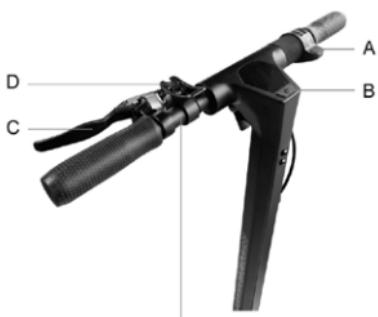
Pospeševalnik (A): pritisnite navzdol, da pospešite.
