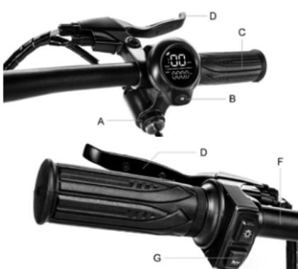
Bloc de contact (A), pour allumer / éteindre l'écran, insérer la clé dans la serrure du bloc de contact et tournez la clé vers la droite.
