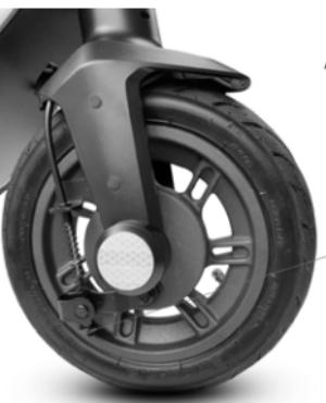
V primeru, da je zavora prenapeta ali preveč ohlapna, z imbus ključem odvijte vijak (A), nato nastavite zavorno vrv (če je prenapeta, skrajšajte zavorno vrv navzgor. Če je ohlapna, povlecite zavorni kabel navzdol) in nato ponovno privijte vijak (A).
