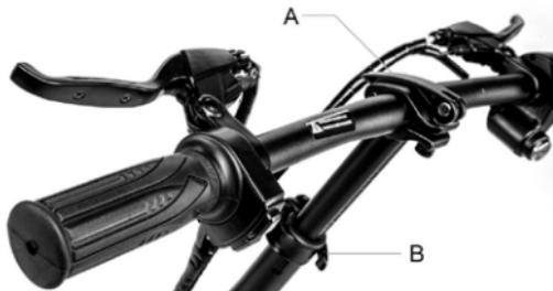
Es posible regular la inclinación del manubrio aflojando la palanca en el manubrio (A), girando el manubrio hacia arriba/abajo.
