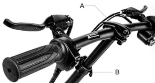
Można regułować nachylenie kierownicy, obłuzując dźwignię na kierownicy (A) i przenosząc kierownicę w góre/w dół.
