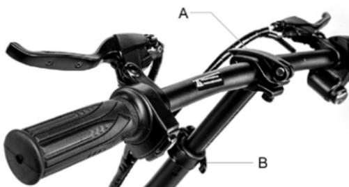
Sklon řídítka lze nastavit uvolněním páčky na řídítkách (A) a otočením řídítka nahoru/dolů.
