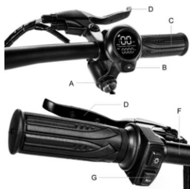
Brava za uključivanje (A), za uključivanje/isključivanje zaslona Umetnite ključ u bravu za paljenje i okreignite ključ udesno.
