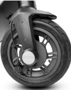
En el caso en que el freno esté demasiado apretado o demasiado flojo, utilizar la llave Allen para aflojar el tornillo (A), luego regular el cable del freno, (acortar el cable del freno hacia arriba si está demasiado estrecho, si está demasiado flojo, tirar el cable del freno hacia abajo) y luego, apretar de nuevo el tornillo (A).
