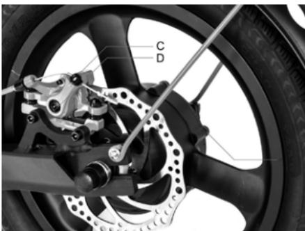
Gebruik, in geval de rem te strak of te ontspannen is, de inbussleutel om de schroef (C) los te draaien; pas vervolgens de remkabel aan (kort de remkabel naar boven in indien te strak, of trek de remkabel omlaag indien te ontspannen); scherp tenslotte de schroef (C) weer aan. Als de rem ook na deze eerste stap te strak of te ontspannen is, dan zou het noodzakelijk kunnen zijn om het (vaste) remblok af te stellen: gebruik de inbussleutel om het remblok (D) verder weg / dichter bij te brengen.
