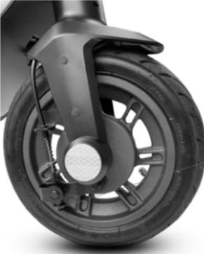
V prípade, ak je brzda príliš pritiahnutá alebo príliš povolená, použite imbusový kľúč na uvoľnenie skrutky (A), potom nastavte brzdový kábel, (skráťte brzdový kábel smerom nahor, ak je veľmi uvoľnený, pritiahnite brzdový kábel smerom nadol) a potom znova utiahnite skrutku (A).
