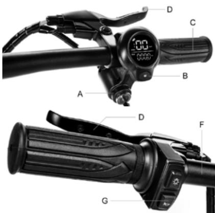
Tambor de encendido (A), para encender/apagar el display introducir la llave en el tambor de encendido y girar la llave hacia la derecha.
