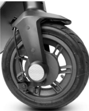
Als de rem te strak of te los zit, handel dan door de schroef (A) los of vast te draaien.
