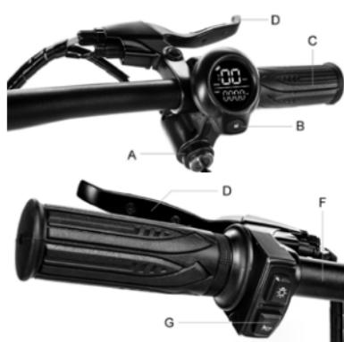
Блок за включване (A), за включване/ изключване на дисплея, поставете ключа в блока за включване и завъртете ключа надясно.
