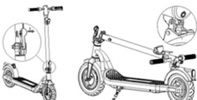
Upewnić się, że hulajnoga elektryczna jest wyłączona. Przytrzymaj drążek kierownicy jedną ręką, pociągnij za dźwignię, złoż drążek kierownicy w kierunku podium i zaczep go.
