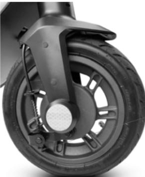
U slučaju da je kočnica previše zategnuta ili prelabava, imbus ključem otpustite vijak (A), zatim podešite sajlu kočnice (skratite sajlu kočnice prema gore ako je prečvrsto, je prelabavo, povucite kočnicu kabel prema dolje), a zatim ponovno zategnjte vijak (A).
