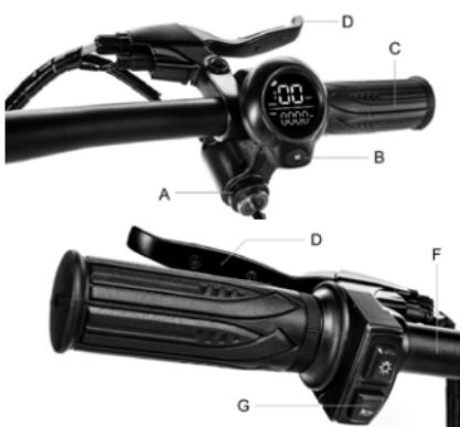
Comutator de contact (A): pentru a porni/opri afișajul, introduceți cheia în contact și roțiți-o spre dreapta.
