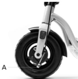
Wenn die Bremse zu fest oder zu locker ist, lösen oder ziehen Sie die Schraube (A) an.
