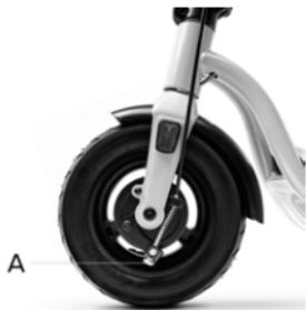
En el caso en que el freno esté demasiado ajustado o demasiado flojo, proceder aflojando o apretando el tornillo (A). Si la palanca del freno está demasiado suave o demasiado dura incluso después de haber realizado el primer pasaje pondría ser necesario repetir la operación hasta que se alcance una configuración ideal.
