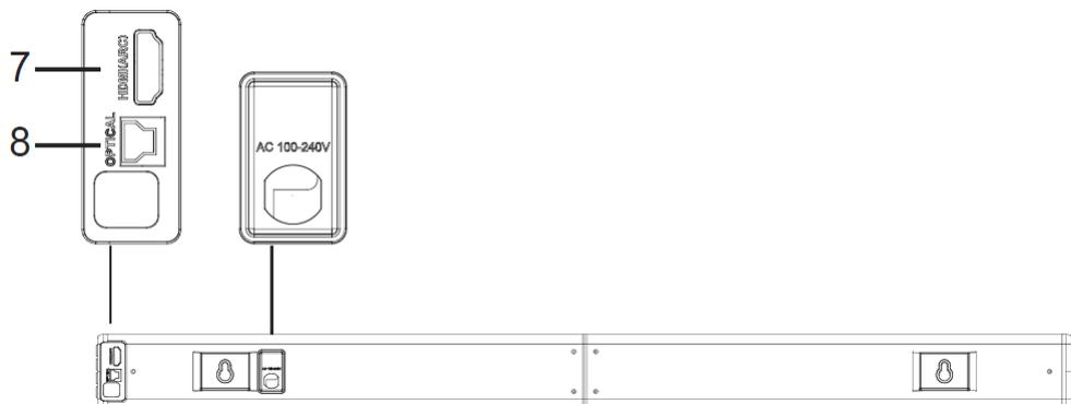
**7. HDMI(ARC)** : à connecter sur la prise HDMI ARC de la TV
