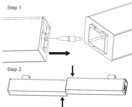
1. Branchez le câble jack 3.5mm stéréo de la partie gauche dans le réceptacle jack 3.5mm stéréo de la partie droite
