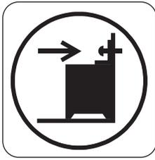
1. Installez la protection anti-bascule à une distance de 232 mm à 237 mm en-dessous de la surface supérieure de l'appareil et à une distance de 110 mm à 115 mm du côté de l'appareil, dans l'orifice circulaire situé sur un support. Vissez-la dans un matériau solide ou utilisez un renfort adapté (mur).
