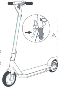
⚠ Betätigen Sie den Bremshebel und vergewissern Sie sich, dass die Bremsleistung normal ist.
