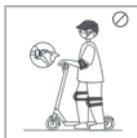
Betätigen Sie beim Schieben des Elektrorollers nicht den Gasregler.
