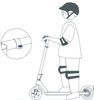
12. Möchten Sie die Geschwindigkeit wieder verringern oder abbremsen, lassen Sie den Gasregler los oder betätigen Sie den Bremshebel.
