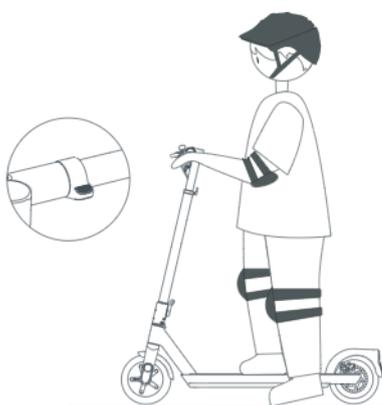
12. Rilasciare la maniglia di accelerazione per ridurre la velocità e premere la leva del freno per frenare.
