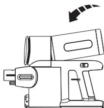
Pour l'installer, insérez le SwitchPro Motor dans l'aspirateur, poussez-la, l'installation est terminée lorsque vous entendez un clic.
