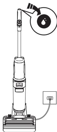
1. Placez l'appareil sur la station de recharge après l'utilisation, le capteur détecte automatiquement le niveau de saleté.
