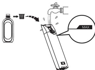
Ouvrez le bouchon du réservoir, puis remplissez-le d'eau du robinet jusqu'à la ligne Max. Si un nettoyage en profondeur est nécessaire, ajoutez un bouchon de flacon de solution dans le REP et fermez fermement le bouchon.
