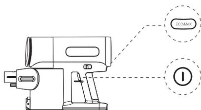
Appuyez sur le bouton ① pour que l'appareil démarre en mode ECO par défaut. Appuyez à nouveau sur ce bouton pour éteindre l'appareil. Passez du mode ECO au mode MAX en appuyant sur le bouton **ECO/MAX**.
