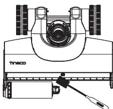
Retirez les cheveux et les débris du compartiment du rouleau brosse et de l'ouverture à l'aide de l'outil de nettoyage.
