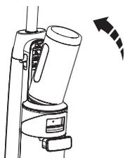
Pour l'installer, insérez le SwitchPro Motor dans le laveur de plancher, poussez-la, l'installation est terminée lorsque vous entendez un clic.
