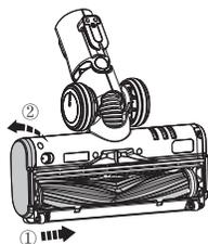
Réinsérez complètement le rouleau brosse dans la fenêtre de brosse et le couvercle d'extrémité peut être tourné dans le sens antihoraire jusqu'à ce qu'il se fermement remette en place.
