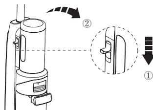
Pour retirer le SwitchPro Motor, tenez l'appareil d'une main et appuyez sur le curseur de libération de l'autre main.
