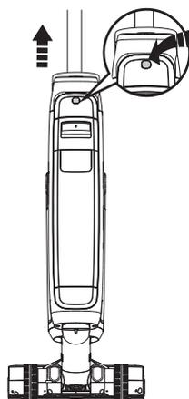
Pour retirer la poignée, appuyez sur le bouton de déverrouillage situé à l'arrière de l'appareil, puis tirez la poignée vers le haut.
