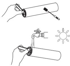
Utilisez l'outil de nettoyage pour retirer les cheveux et les débris enroulés autour du rouleau, puis rincez le rouleau à l'eau et laissez-le sécher complètement avant de le réinstaller.
