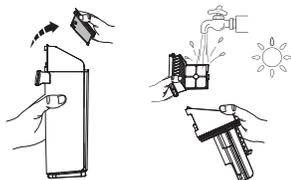
Saisissez les zones en creux de chaque côté du filtre sec et tirez vers le haut. Rincez sous l'eau courante et laissez sécher complètement avant de replacer le filtre sec dans le couvercle du RES.
