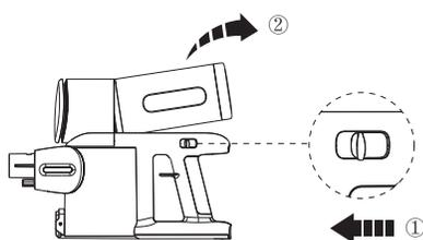
Pour retirer le SwitchPro Motor, tenez l'appareil d'une main et appuyez sur le curseur de libération de l'autre main.
