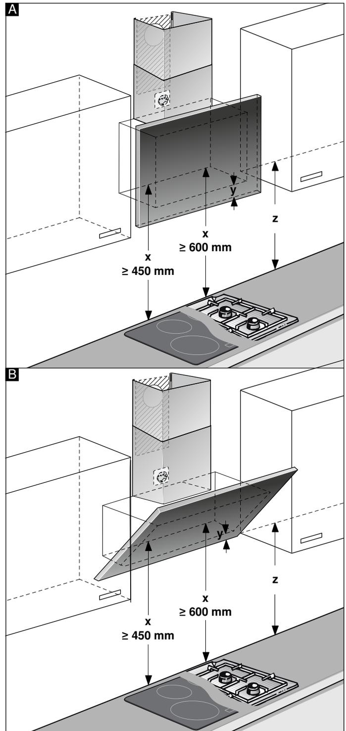
2. Posez le gabarit sur la ligne pré-marquée et fixez-le. Marquez les positions des vis. Pour l'installation du capot de cheminée, le gabarit doit être séparé à l'intersection indiquée.
