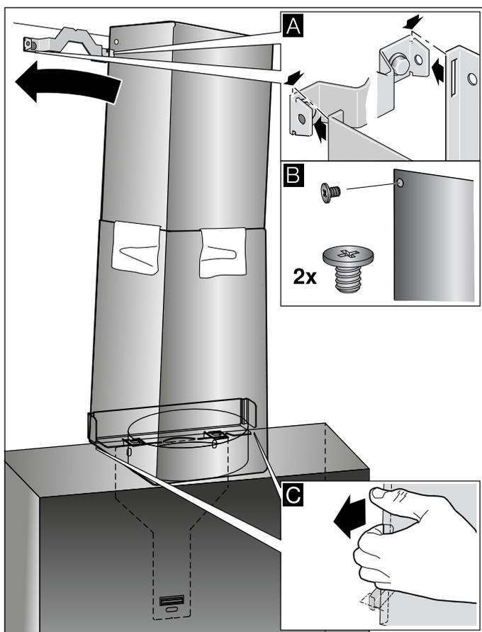
7. Clipsez le capot de cheminée inférieur contre la cornière de retenue. Le câble d'alimentation ne doit pas être endommagé ! **C**
