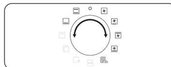
2. Tournez la molette de sélection du mode pour sélectionner un mode de cuisson. Vous pouvez sélectionner le mode Gril, Convection ou Chaleur supérieure + Convection sur le compartiment supérieur, et le mode Convection, Chaleur inférieure + Convection ou Chaleur inférieure sur le compartiment inférieur.
