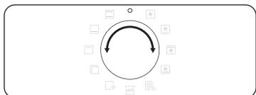
Pendant que la cuisson est en cours, tournez le sélecteur de mode sur « **O** ». Le four s'éteint en quelques secondes. En effet, pour éviter d'accepter des commandes incorrectes de la part des utilisateurs, le four attend quelques secondes pour qu'ils puissent corriger leur sélection.
