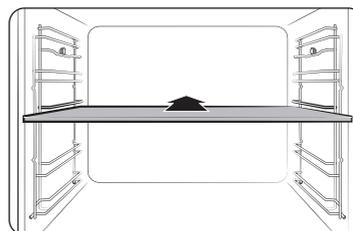
1. Insérez la plaque séparatrice sur le niveau 3 pour diviser l'enceinte de cuisson en deux compartiments.
