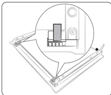
7. Vérifiez que les caoutchoucs de vitre sont correctement positionnés et fixez les couches vitrées.
