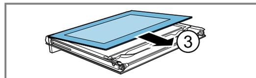
5. Appuyez vers le bas sur la vitre intermédiaire dans la zone [a] soulevez avec précaution la fixation [b] jusqu'à ce qu'elle puisse être retirée.
