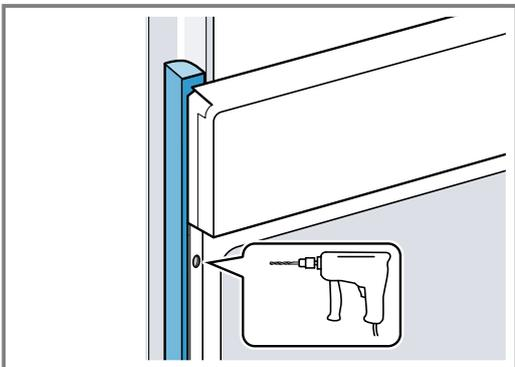
4. Fixez l'appareil avec une vis adéquate.
