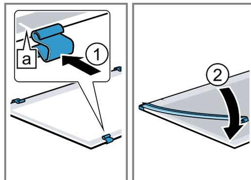
3. Placez la vitre intermédiaire avec les joints et les écarteurs dans le sens de la flèche ①. La flèche sur la vitre intermédiaire doit correspondre avec celle du cadre [a].
