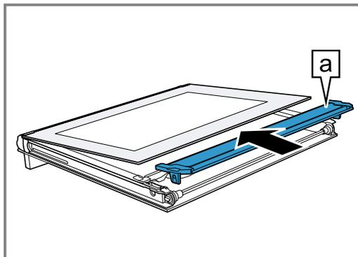
8. Insérer la vitre intérieure avec la fixation [a] dans l'ouverture.
