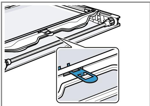
6. Placer la vitre intérieure sur la porte de l'appareil de sorte que le numéro [a] à droite en bas soit lisible. Insérer la vitre intérieure en biais vers l'arrière dans le rail de fixation [b].
