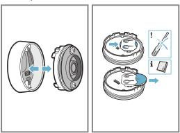
3. Mettre en place une nouvelle pile en observant les instructions relatives aux pôles de la pile. Utiliser uniquement des piles de qualité de type CR2032.
