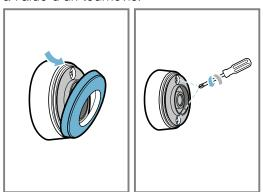
2. Ouvrir le couvercle du capteur pour casserole et retirer la pile du socle.
