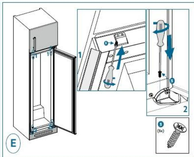
5. Vissez un guide dans les trous du côté de l'appareil. Insérez la glissière dans le guide et vissez-la à la porte. Dévissez le guide pour visser la dernière vis de la glissière sur la porte. Fixez ensuite le cache de la glissière sur la glissière. Vissez à nouveau le guide sur l'appareil en y insérant la glissière.
