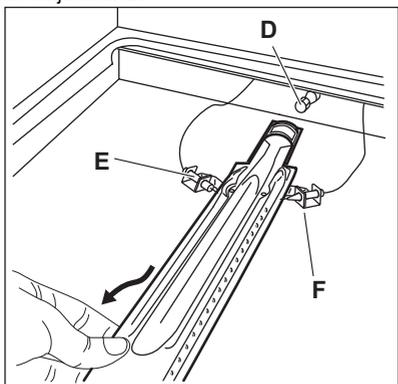
4. Déplacez-le ensuite lentement vers la gauche. Assurez-vous que la bague du brûleur reste sur l'embout de ce dernier. Ne forcez pas sur le câble du connecteur de la bougie d'allumage F ni sur le conducteur du thermocouple E.
