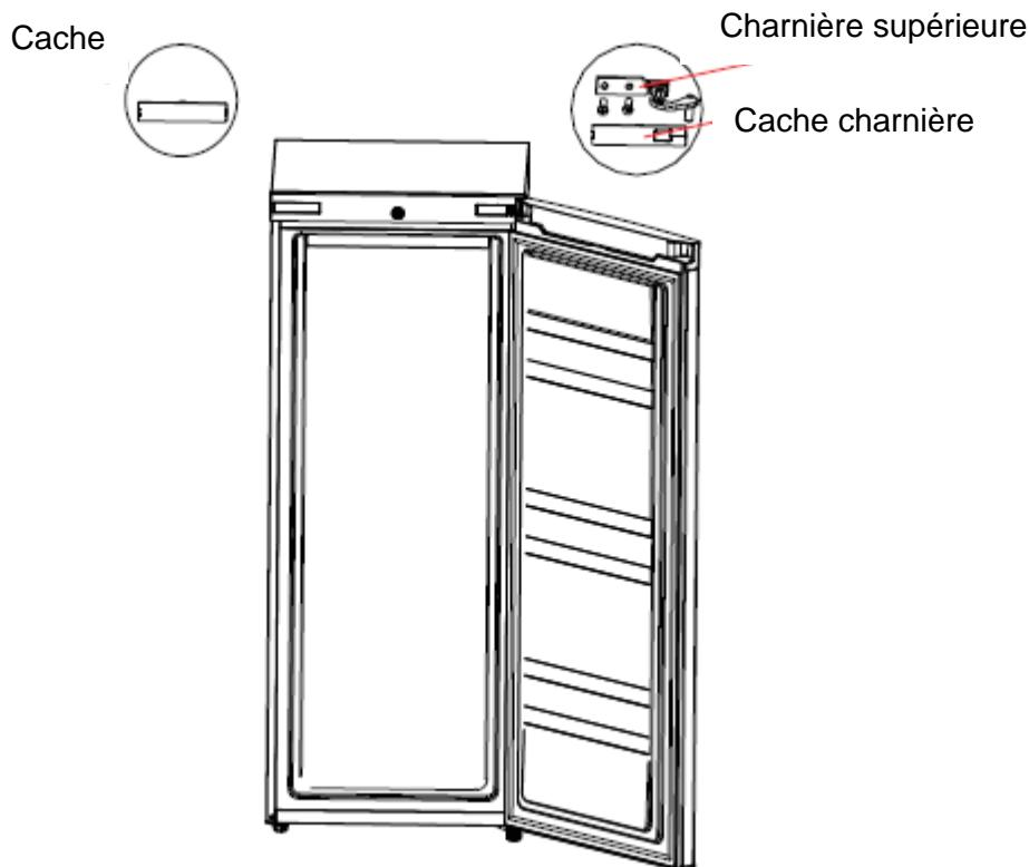
2. Démontez la porte et l'assemblage de la charnière inférieure et le pied réglable, puis rassemblez l'assemblage de la charnière inférieure et le pied réglable de l'autre côté.
