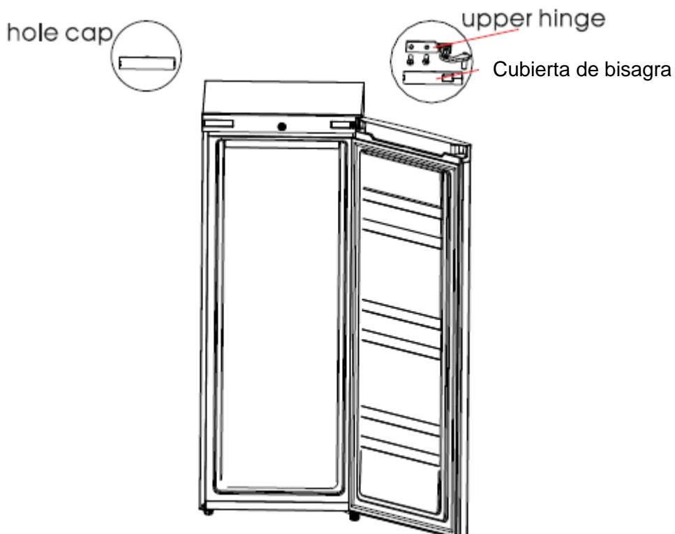
2. Desmonte la puerta y el conjunto de la bisagra inferior y la pata ajustable, luego monte el conjunto de la bisagra inferior y la pata ajustable en el otro lado.
