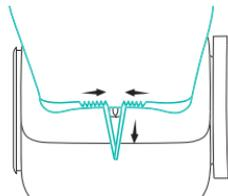
4 - Insérer le cordon de serrage dans l'espace prévu, serrer et enrouler.
