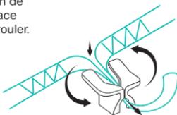
5 - Après l'installation, vérifier que le clapet n'est pas bloqué et peut s'ouvrir et se fermer normalement. Positionner l'arrière du sac afin de lui éviter d'être pris dans le couvercle.
