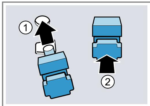
3. Accrocher les fixations arrière avec le crochet dans le trou supérieur ① et les pousser dans le trou inférieur ②.
