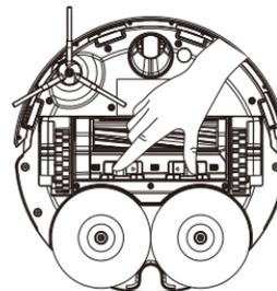
2. Retirer la brosse principale en caoutchouc souple, retirer le roulement de la brosse principale en caoutchouc souple, tourner et retirer les capuchons de la brosse principale en caoutchouc souple dans le sens indiqué pour le déverrouillage, retirer les poils et la saleté emmêlés aux deux extrémités de la brosse principale en caoutchouc souple,
