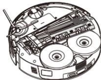
4. Remettez en place le couvercle de la brosse principale en caoutchouc souple sur le robot et assurez-vous que 3 dents du couvercle sont insérées dans les fentes correspondantes.
