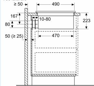
En cas d'installation directement contre des murs extérieurs qui ne sont pas isolés ( $\mu \geq 0,5 \text{ W/m}^2\text{°C}$ ), nous recommandons d'utiliser des configurations de recyclage partiellement ou totalement gainées.
