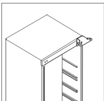
3. Retirez le cache et les vis du côté gauche et placez-les du côté droit
