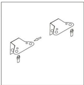
8. Relevez l'appareil et placez la porte sur la charnière du bas. Vérifiez que la tige de la charnière inférieure est insérée dans le trou de la porte. Installez ensuite la charnière supérieure sur la porte. Avant de resserrer la charnière supérieure, essayez d'ouvrir la porte afin de vérifier que l'appareil se ferme hermétiquement. Enfin, vissez le cache-charnière sur la charnière
