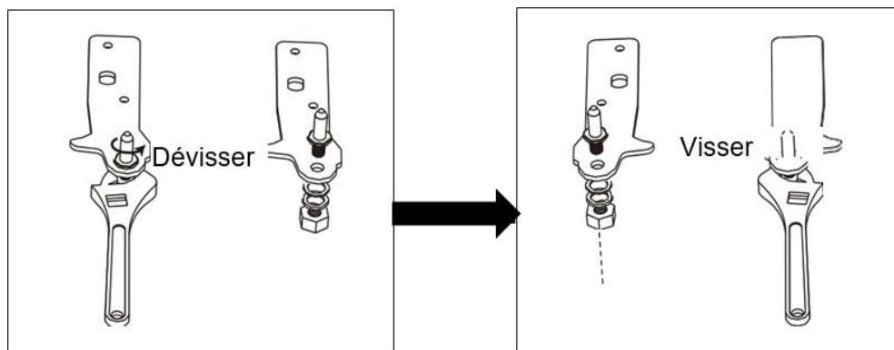
6. Installez la charnière du côté gauche et la base du pied du côté droit. Vissez ensuite les deux pieds de réglage avec leurs pièces d'origine.
