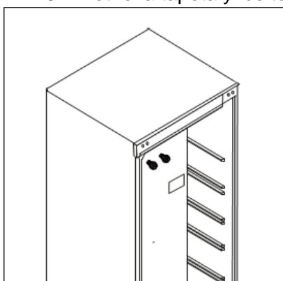
4. Apoye con cuidado la parte trasera del armario sobre una superficie acolchada. Quite las dos patas de ajuste. Suelte la bisagra de la puerta y la base de la pata del lado izquierdo.
