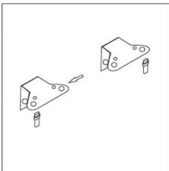
8. Σηκώστε τη συσκευή και τοποθετήστε την πτώρα στον κάτω μενισέ. Ελέγχετε ότι η ράβδος του κάτω μενισέ έχει εισαχθεί στην οπή της πτώρας. Στη συνέχia, τοποθετήστε τον επάνω μενισέ στην πτώρα. Πριν σφίξετε τον επάνω μενισέ, προσπαθήστε να ανοίξετε την πτώρα για να ελέγχετε ότι η συσκευή κλείνει καλά. Τέλος, βιδώστε το κάλυμμα μενισέδων στον μενισέ
