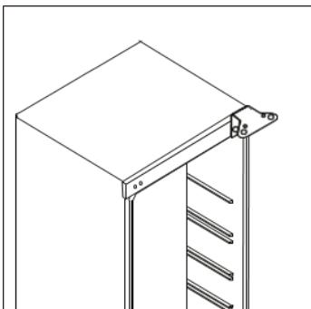
3. Retire la tapeta y los tornillos de la izquierda y colóquelos en la derecha.
