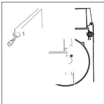
Attention ! Si une vis est présente dans l'angle avant gauche, retirez-la avant d'installer la charnière
