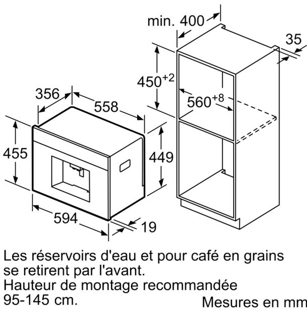
Les réservoirs d'eau et pour café en grains se retirent par l'avant.
