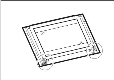
5. Désengagez le système de verrouillage pour retirer le panneau de verre intérieur.
