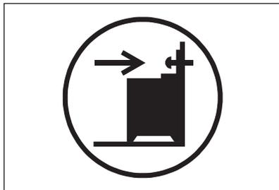
1. Installez la protection anti-bascule de 232 à 237 mm en dessous de la surface supérieure de l'appareil et de 110 à 115 mm du côté de l'appareil, dans l'orifice circulaire situé sur un support. Vissez-le dans un matériau solide ou utilisez un renfort adapté (mur).
