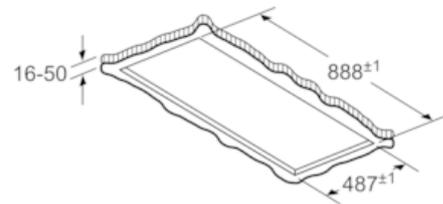
Ne pas monter directement sur un faux plafond constitué de plaques de plâtre ou d'un matériau de construction léger similaire. Il est impératif d'utiliser un support adapté et solidement fixé dans la dalle en béton.
