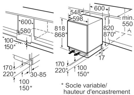
Place pour le raccordement électrique sur le côté à droite ou à gauche à côté de l'appareil. Entrée et sortie d'air dans le socle.
