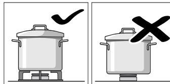
Stellen Sie große Töpfe nicht auf die Brenner in der Nähe der Armaturen. Diese könnten überhitzt und dadurch beschädigt werden.
