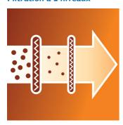
Le système de filtration à 2 niveaux permet de garder toute la poussière à l'intérieur de l'appareil. Le premier filtre piège la majeure partie de la poussière, tandis que le deuxième piège les particules les plus fines.
