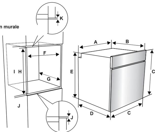
Une fois les branchements électriques effectués, insérer le four dans son emplacement en la poussant vers l'avant. Ouvrir la porte du four et insérer 2 vis dans les trous du châssis du four. Lorsque le châssis du produit touche la surface du bois du meuble, serrer les vis.
