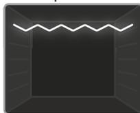
**Fonction Gril :** Le voyant du thermostat et la lampe témoin du four s'allument, et la résistance du gril commence à chauffer. Cette fonction sert à
