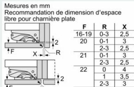
Les dimensions d'espace libre recommandées dans le tableau doivent être respectées afin d'assurer une ouverture sans collision des portes de l'appareil, et d'éviter ainsi d'endommager les meubles de cuisine.
